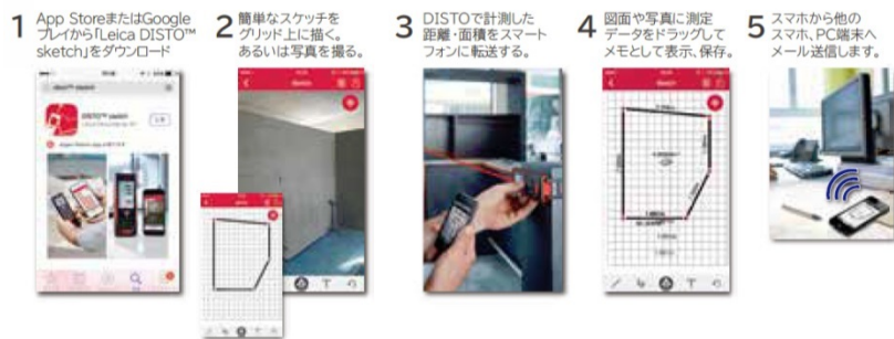
図2 専用アプリ『Leica DISTO™ sketch』で測る・メモる・送る
