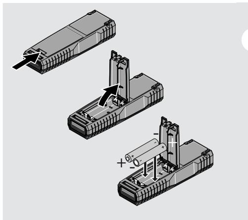
**i** 製品スペック確保のため、マンガン電池を使用しないでください。電池残量のアイコンが点滅した時には、電池交換して下さい。
